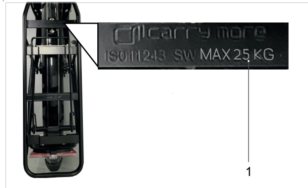
Abbildung 128: Auf dem Gepäckträger ist seine maximale Tragfähigkeit (1) ausgewiesen.
