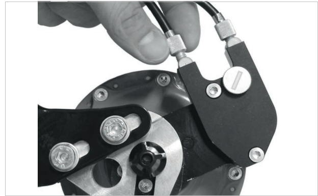
Abbildung 184: ROHLOFF-Naben Versionen mit externer Schaltansteuerung haben die Zugeinsteller an der Seilbox, die sich auf der linken Seite befindet
