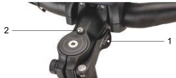
63. ábra: II kivitelű kormányzár a kormányzár-gyorszár (1) gyorskioldójával és reteszelésoldó gombbal (2)
