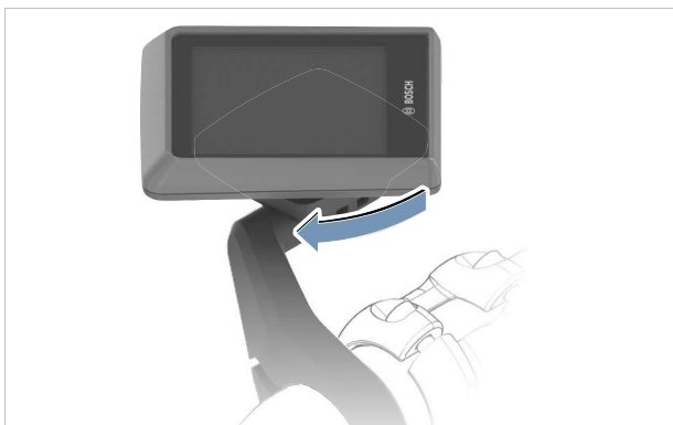
107. ábra: A kijelző elforgatása az óramutató járásával egyező irányban
