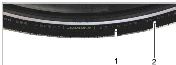
154. ábra: Guminyomás bar-ban (1) és psi-ben (2)
