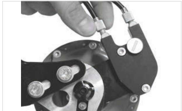
Figura 169: Las versiones de bujes ROHLOFF con activación de cambio externa tienen los dispositivos de ajuste de tensión en la caja de cables que se encuentra en el lado izquierdo
