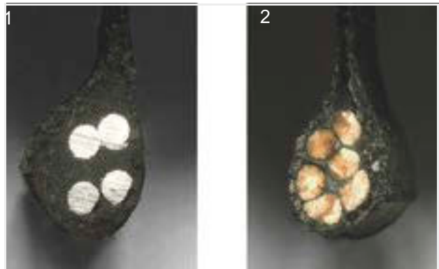
Figura 13: Núcleo de acero (1) y núcleo de Kevlar (2)
