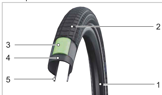
Figura 12: Estructura de las cubiertas abiertas
