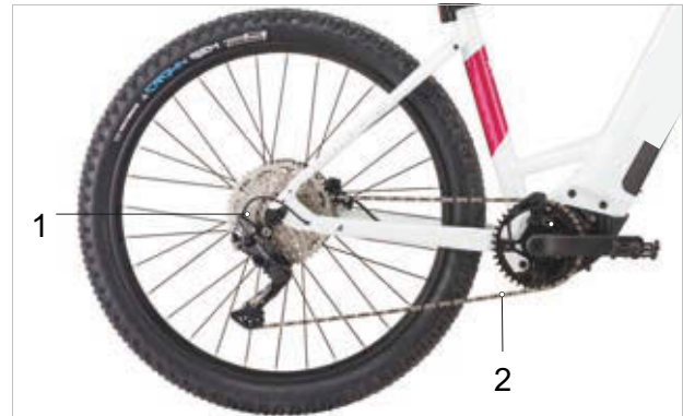
Figura 30: Esquema de la transmisión por cadena con cambio de cadena
