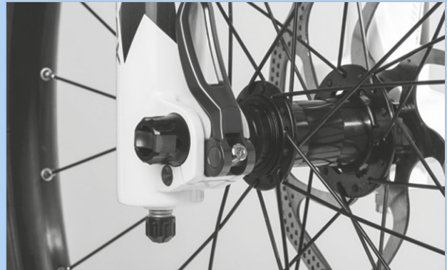
Figura 172: Ajuste de la fuerza de tensado del cierre rápido
