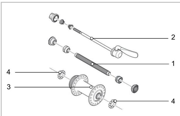
Illustration 17 : Exemple d'un moyeu de roue avant, SHIMANO
