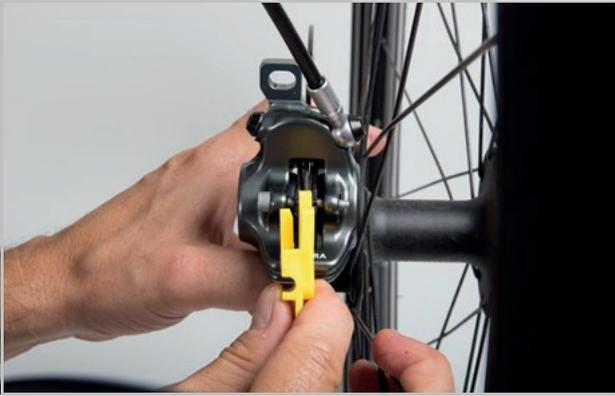
Illustration 125 : Contrôler la plaquette de frein montée à l'aide de la cale de transport
