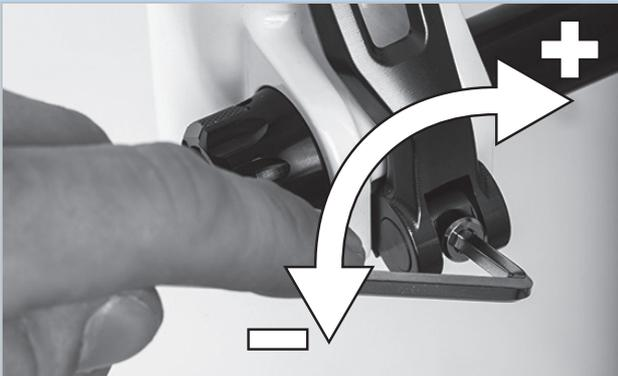
Illustration 144 : Régler la force de serrage de l'attache rapide
