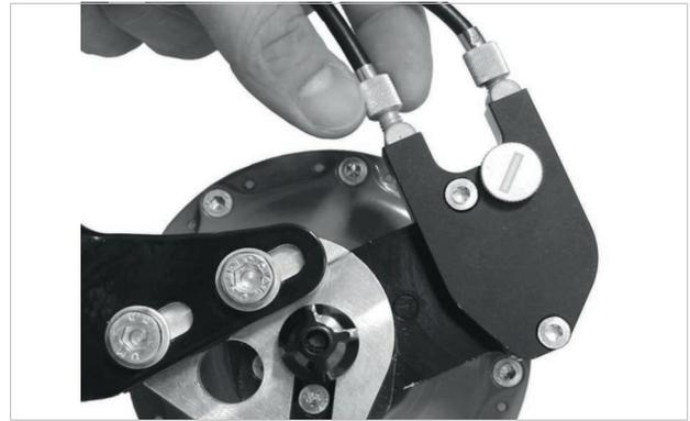
Illustration 140 : Sur les versions de moyeux ROHLOFF avec commande externe du changement de vitesse, le dispositif de réglage de la tension est situé sur le boîtier de câbles qui est placé sur le côté gauche.
