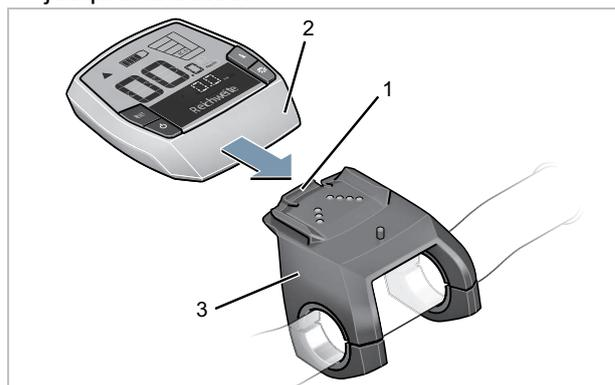
Illustration 89 : Enfoncez l'ordinateur de bord (2) via le dispositif de blocage de l'ordinateur de bord (1) jusqu'à la butée du support (3)
