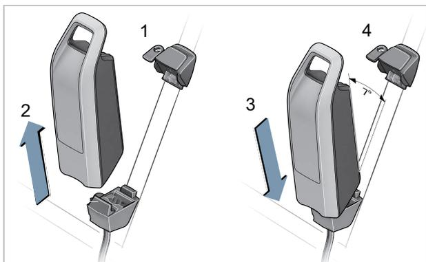
Illustration 108 : Retirer et insérer la batterie sur cadre
