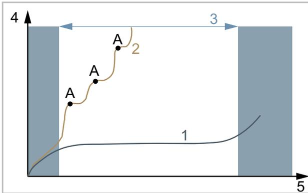
Illustration 119 : Diagramme d'usure, durée de service (5) par rapport à l'enlèvement de matière (4)
