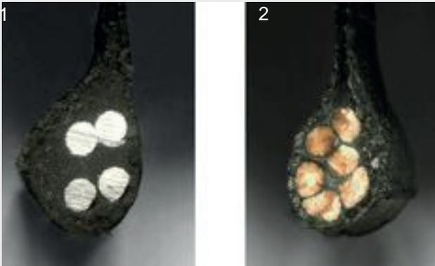
Illustration 12 : tringle en acier (1) et tringle en Kevlar (2)
