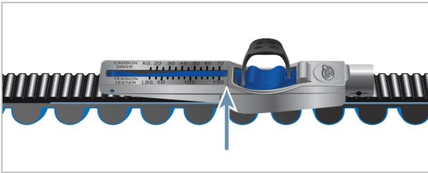
Illustration 131 : Gabarit de contrôle sur la courroie
