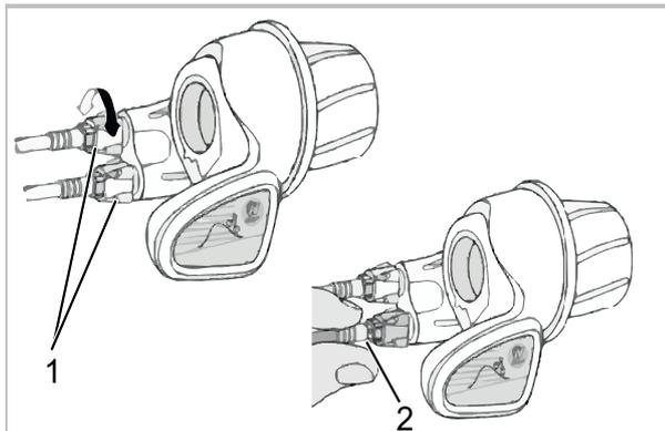
Illustration 142 : Poignée de vitesse rotative avec douilles de réglage (1) avec jeu de rotation (2)
