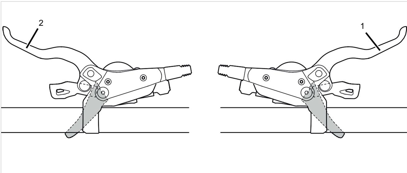
Illustration 43 : Freins à main arrière (1) et avant (2), exemple d'un frein SHIMANO
