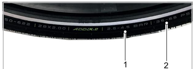
Illustration 122 : Indication de pression des pneus en bar (1) et psi (2)
