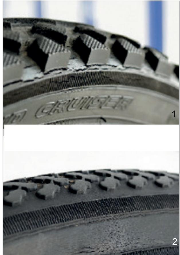
Illustration 124 : Exemples de fissures de fatigue (1) et de fissures d'âge (2)
