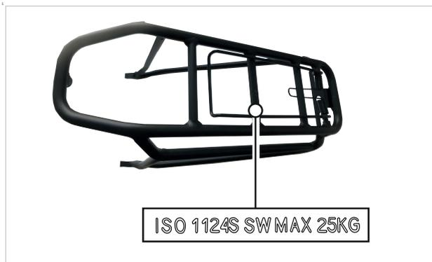
Illustration 104 : La capacité de charge maximale (1) est indiquée sur le porte-bagages.
