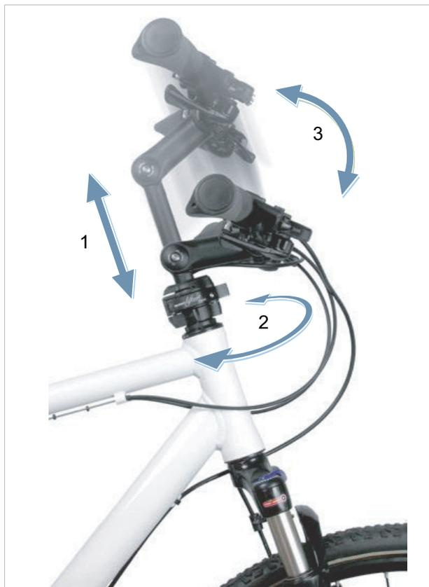
Illustration 4 : Exemple d'un BY.SCHULZ Speedlifter Twist Pro SDS
