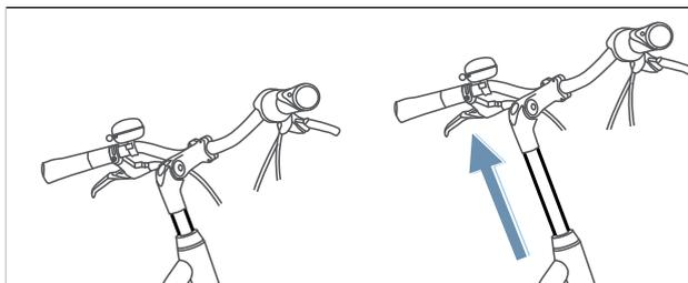
Illustration 74 : Régler la hauteur de la potence à plongeur
