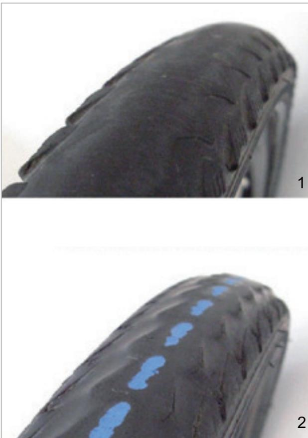
Illustration 123 : Pneu sans profil pouvant être changé (1) et pneu avec protection anti-crevaison visible (2) devant être changé
