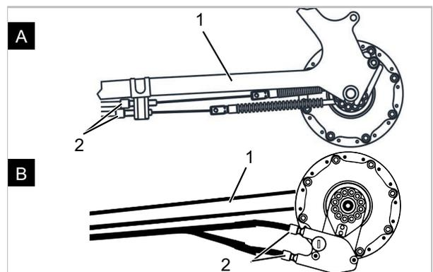
Illustration 141 : Douilles de réglage (2) sur deux modèles alternatifs (A et B) d'un changement de vitesse actionné par câble à deux câbles sur la base de cadre (1)
