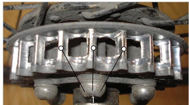
Illustration 129 : Exemple de photo d'un profil de cran usé
