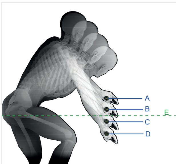
Illustration 82 : Exemple de 4 hauteurs de guidon différentes (A, B, C et D) avec une hauteur de selle (E)
