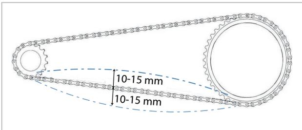
Illustration 138 : Exemple de contrôle de la tension de la chaîne : 5 mm vers le haut, 10 mm vers le bas = écart de 15 mm
