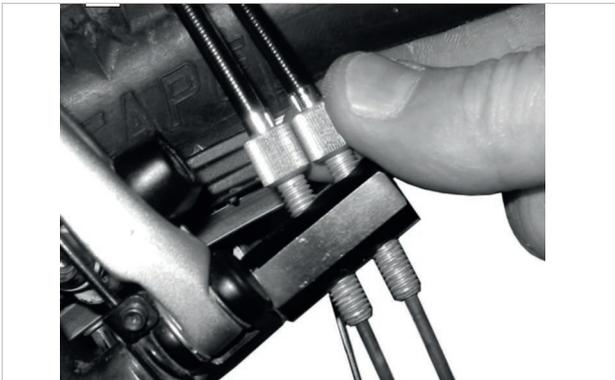
Illustration 139 : Sur les versions de moyeux ROHLOFF avec commande interne du changement de vitesse, le dispositif de réglage de la tension est situé sur le contre-support de tension.
