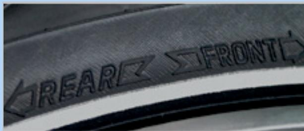
Illustration 50 : Flèche directionnelle sur les pneus VTT
