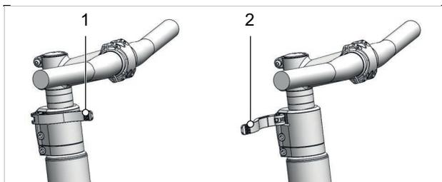
Illustration 72 : Levier de serrage de la potence fermé (1) et ouvert (2), exemple d'un All Up
