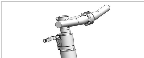
Illustration 115 : Exemple d'un All Up avec levier de serrage de la potence ouvert
