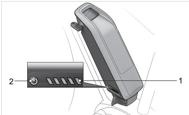
Illustration 45 : Position de l'indicateur de charge de la batterie pour tube de selle
