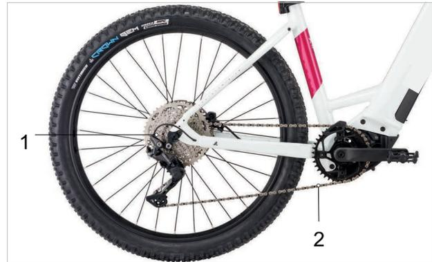
Illustration 30 : Schéma de l'entraînement à chaîne avec dérailleur
