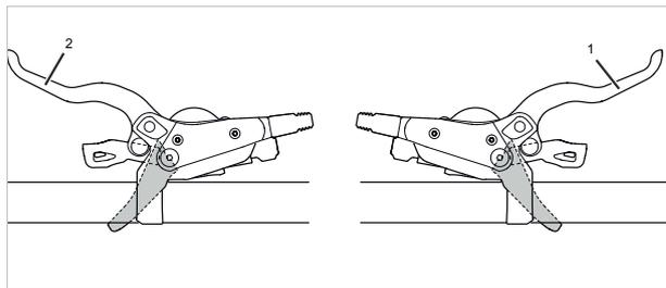
Illustration 109 : Levier de frein arrière (1) et avant (2), exemple d'un frein SHIMANO
