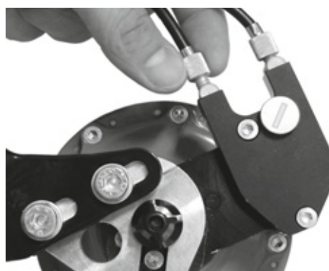
Figura 104: Las versiones de bujes Rohloff con activación de cambio externa tienen los dispositivos de ajuste de tensión en la caja de cables que se encuentra en el lado izquierdo
