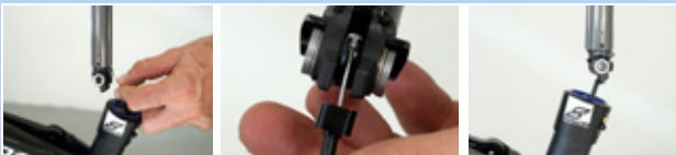
Figura 169: Enganchar e insertar la tija de sillín
