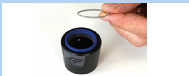
Figura 155: Arandela elástica retirada
