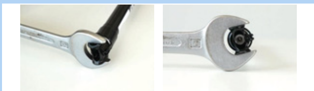
Figura 132: Aseguramiento para evitar el giro
