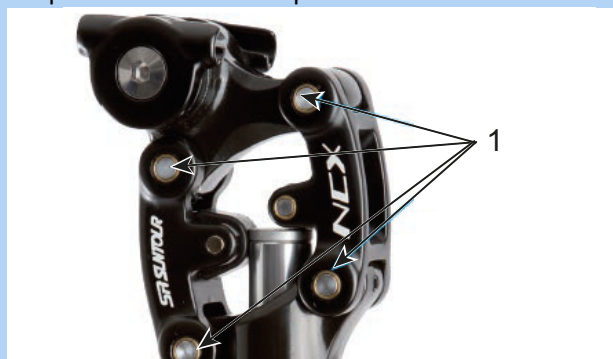
Figura 110: Puntos de lubricación de la tija de sillín de muelle SR Suntour
