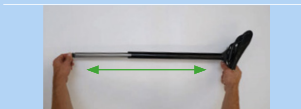
Figura 163: Separación de la tija de sillín
