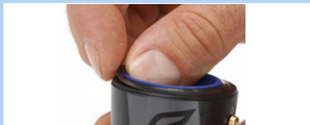
Figura 154: Retirada del anillo con falda de obturación
