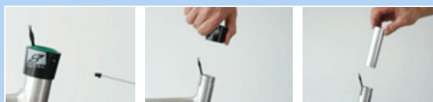
Figura 119: Desmontaje del manguito exterior y del casquillo deslizante
