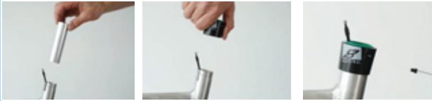
Figura 168: Montaje del casquillo deslizante y del manguito exterior
