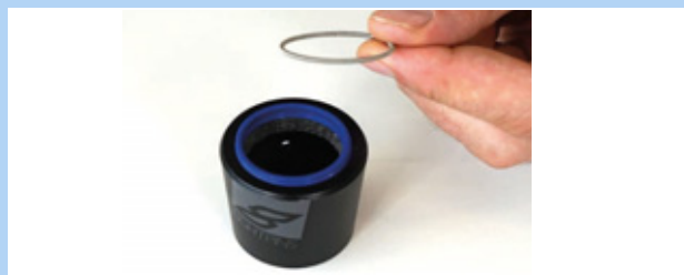
Figura 120: Arandela elástica retirada
