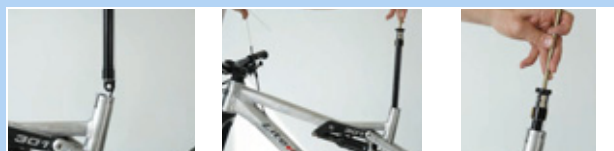
Figura 139: Fijación la tapa de la válvula del cartucho
