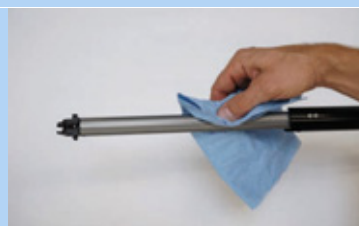
Figura 164: Limpieza de la ranura de guía longitudinal
