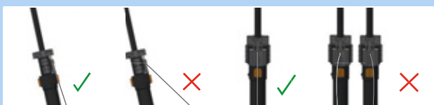
Figura 138: Cable Bowden correcto e incorrecto
