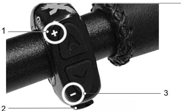
Figura 90: Botones del manillar ROHLOFF E-14
