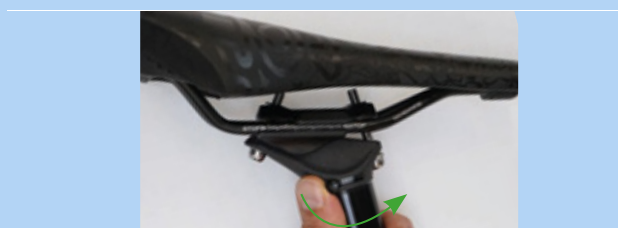
Figura 162: Apertura del ajuste de altura
