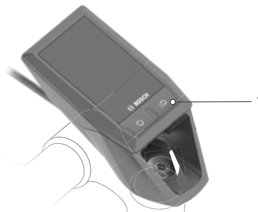
Figura 86: Posición del botón de la luz de marcha
