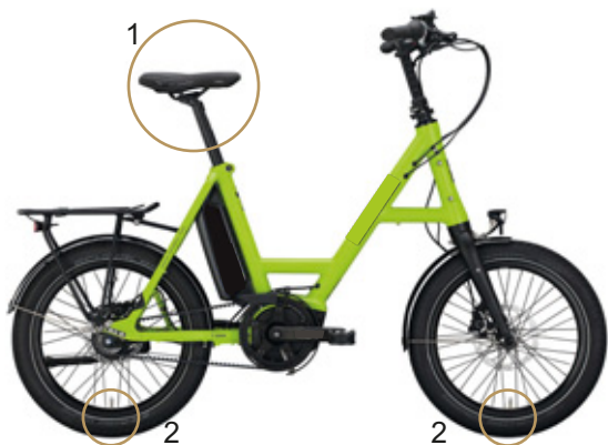
Figura 7: Sistema resistente a las vibraciones
