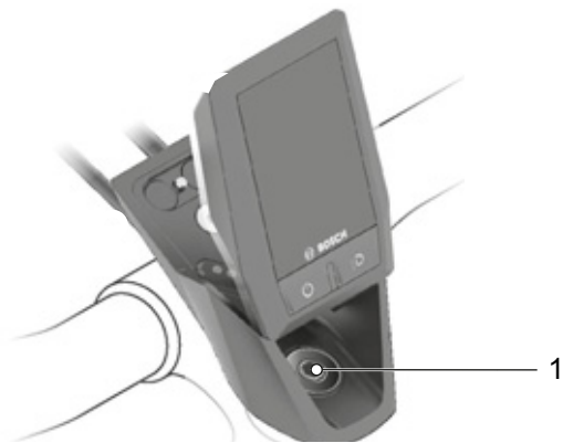
Figura 72: Posición del tornillo del juego de control
