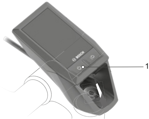
Figura 85: Posición del botón de conexión/desconexión (unidad de mando)
