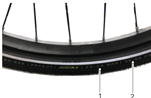
Figura 97: Presión de inflado en bar (1) y psi (2)
