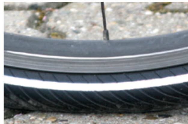
Figura 60: Presión de inflado correcta. La cubierta apenas está deformada bajo la carga del peso corporal
