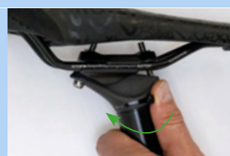
Figura 167: Cierre del ajuste de altura
