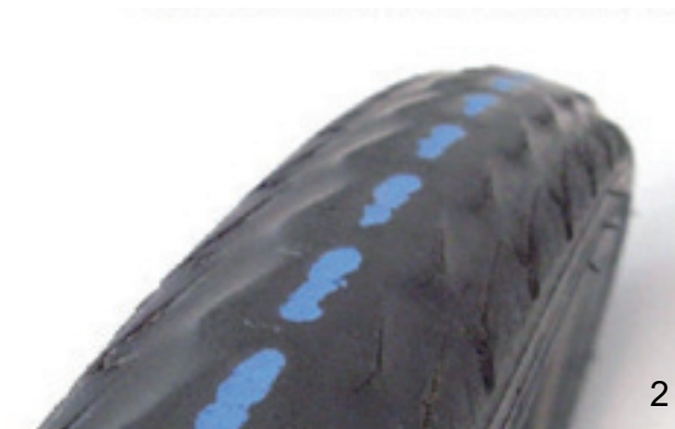
Abbildung 87: Reifen ohne Profil, der gewechselt werden kann (1), und Reifen mit durchscheinendem Pannenschutz (2), der gewechselt werden muss
