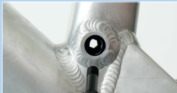
Abbildung 159: Loch der Postpin Schnittstelle
