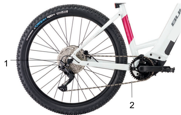
Abbildung 19: Schema Kettenantrieb mit Kettenschaltung
