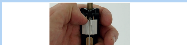
Abbildung 125: Weißer Betätigungsschieber nach unten schieben
