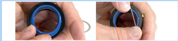
Abbildung 148: Abstreifer einlegen und befestigen
