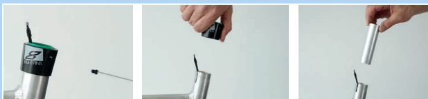
Abbildung 107: Außenhülse und Gleitbuchse ausbauen
