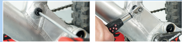
Abbildung 129: Postpin Achse befestigen
