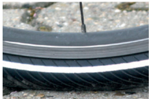
Abbildung 57: Korrekter Fülldruck. Der Reifen ist unter der Last des Körpergewichts kaum verformt.
