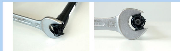
Abbildung 120: Gegen Verdrehen sichern
