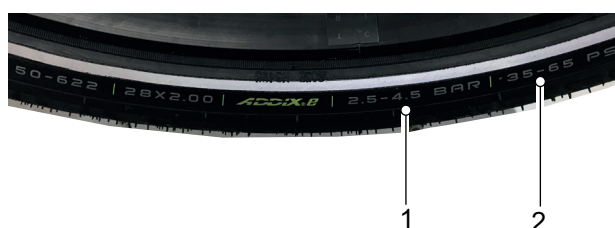
Abbildung 86: Fülldruck in bar (1) und psi (2)
