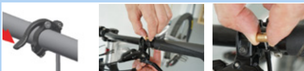
Figur 113: Afmontering af patron
