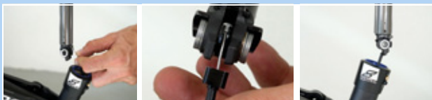
Figur 169: Påhægtning og indskubning af sadelpind
