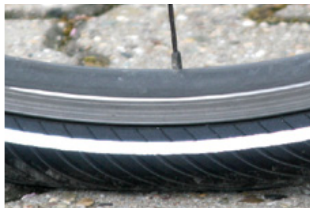
Figur 60: Korrekt dæktryk. Dækkets form er næsten ikke ændret af kropsvægtens belastning
