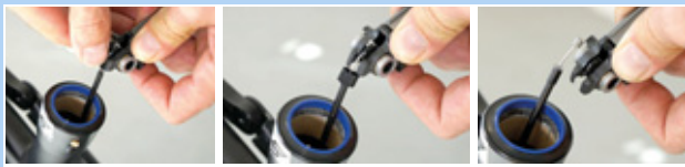
Figur 152: Fjernelse af bowdenkabel
