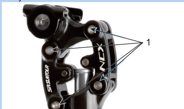
Figur 110: Smørepunkter på SR Suntour affjedret sadelpind
