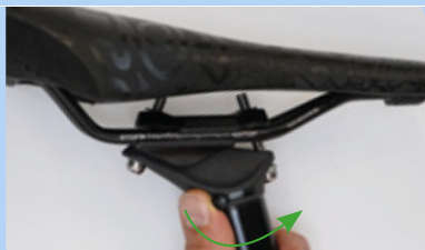
Figur 162: Åbning af højdeindstilling
