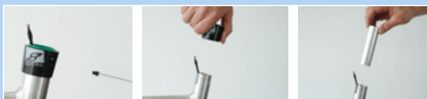
Figur 119: Afmontering af udvendig kappe og glidebøsning
