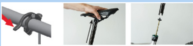
Figur 112: Udtrækning af sadelpind
