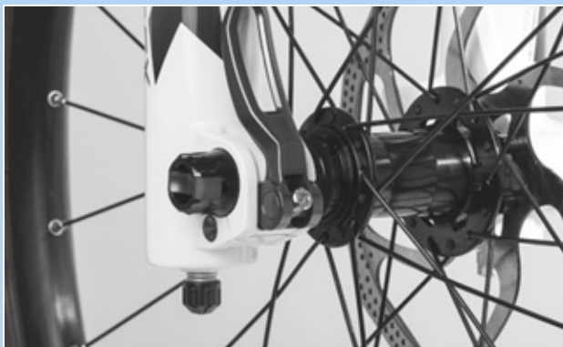
Figur 108: Indstilling af hurtigbespændingens spændekraft
