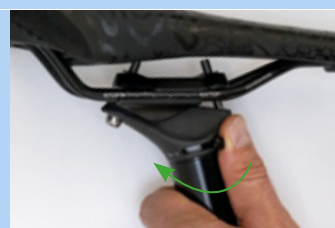
Figur 167: Lukning af højdeindstilling
