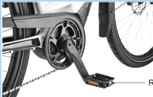
Figur 41: R-pedal i højre pedalarm
