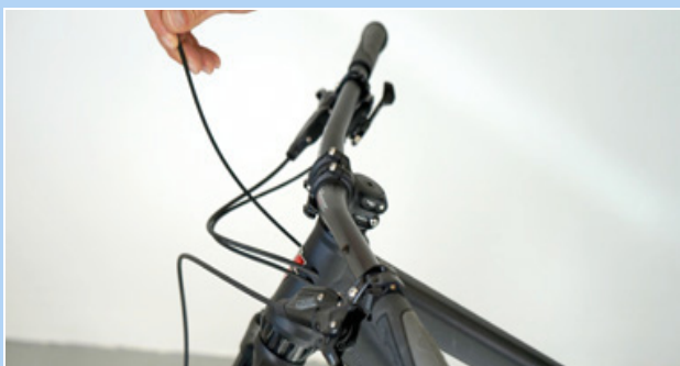
Figur 170: Fasthægtning af endekappe
