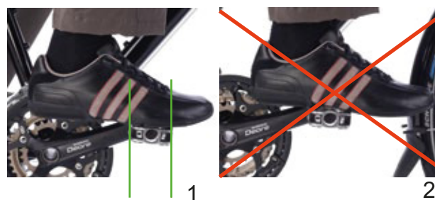
Figur 82: Korrekt (1) og forkert (2) fodposition på pedalen
