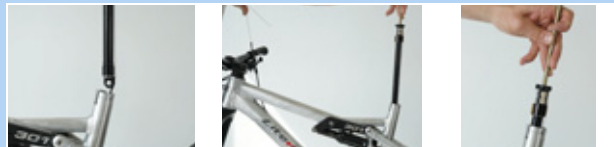
Figur 139: Fastgørelse af patronens ventildæksel
