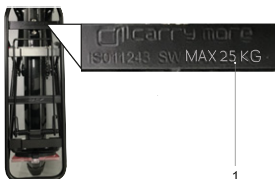
Figur 81: Bagagebærerens maksimale bæreevne (1) er angivet på bagagebæreren
