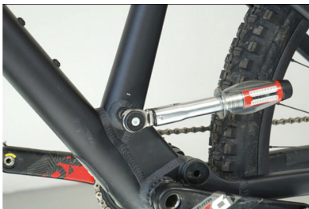
Figur 44: Fastspænding af sadelpindsaksel
