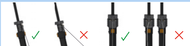
Figur 138: Korrekt og forkert bowdenkabel
