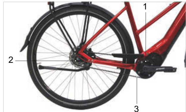
Figura 31: Esquema de la transmisión por correa
