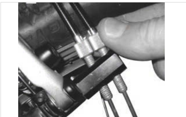
Figura 139: Las versiones de bujes ROHLOFF con activación de cambio interna tienen los dispositivos de ajuste de tensión en el contraapoyo de tensión
