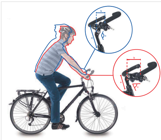
Figura 77: Posición de la bicicleta de ciudad (azul) y la bicicleta de trekking (rojo) mediante la modificación angular
