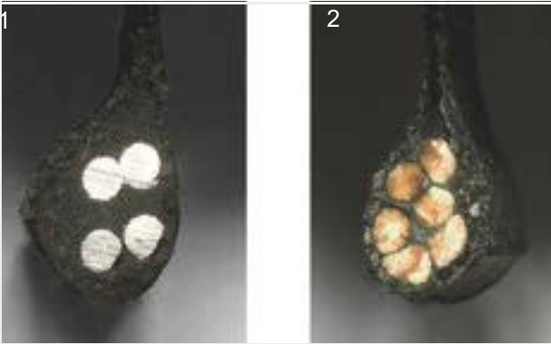
Figura 12: Núcleo de acero (1) y núcleo de Kevlar (2)
