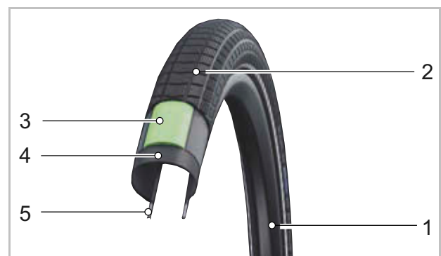
Figura 11: Estructura de las cubiertas abiertas
