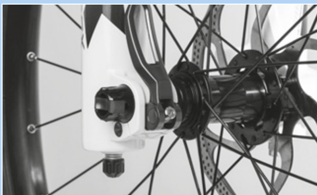
Figur 97: Indstilling af hurtigbespændingens spændekraft
