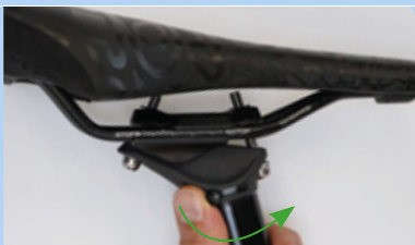
Figur 151: Åbning af højdeindstilling
