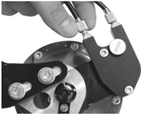
Figur 93: På udgaver af Rohloff-nav med ekstern skifteaktivering sidder kabelindstilleren på wireboksen, som sidder på venstre side
