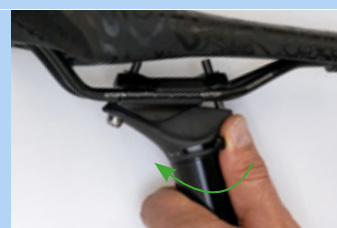
Figur 156: Lukning af højdeindstilling
