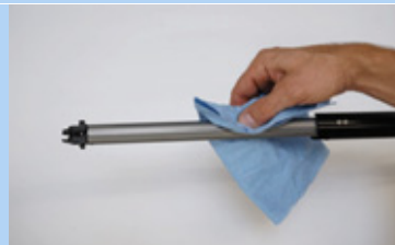
Figur 153: Rengøring af længdeføringsnot
