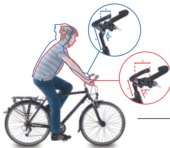
Figur 55: Position for citybike (blå) og trekkingcykel (rød) med vinkelændring
