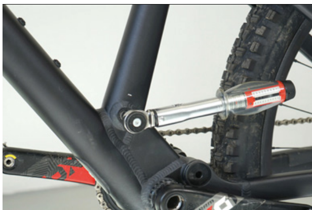
Figur 41: Fastspænding af sadelpindsaksel
