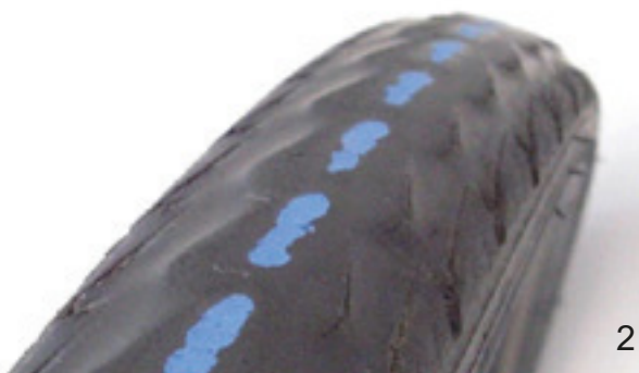
Figur 87: Dæk uden profil, som stadig kan bruges (1), og dæk, hvor punkteringsbeskyttelsen (2) kan ses gennem slidbanen, og som skal udskiftes
