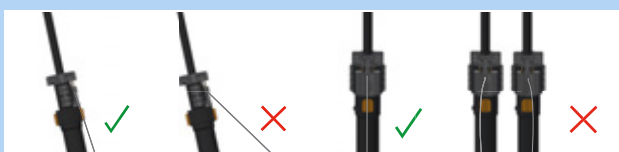
Figur 127: Korrekt og forkert bowdenkabel
