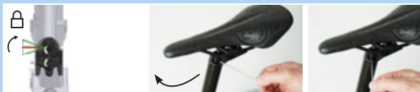
Figur 137: Lukning af højdeindstilling
