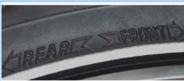
Figura 47: Flecha de sentido de la marcha en cubiertas de MTB
