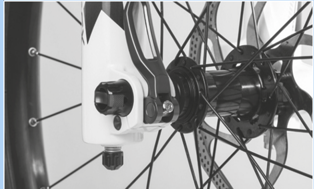
Figura 161: Ajuste de la fuerza de tensado del cierre rápido
