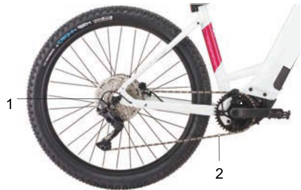
Figura 27: Esquema de la transmisión por cadena con cambio de cadena
