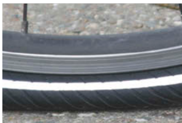
Figura 77: Presión de inflado demasiado baja
