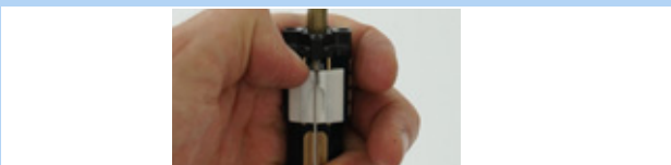
Afbeelding 124: Witte schuif omlaag schuiven
