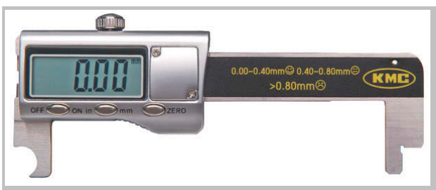
150. ábra: KMC digitális mérőidom példája
