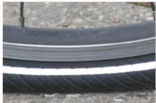
82. ábra: Túlontúl alacsony töltőnyomás
