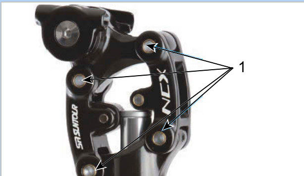
174. ábra: SR SUNTOUR rugós nyeregcső kenőpontjai
