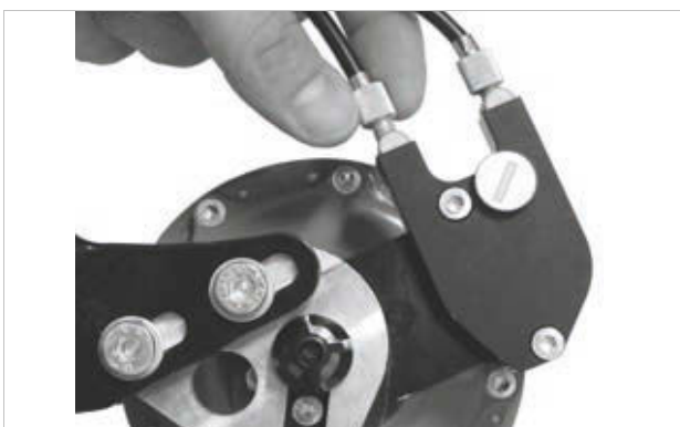
169. ábra: Külső váltóvezérléssel rendelkező ROHLOFF agyváltozatok húzásbeállítója a kötéldobozon van, ami a bal oldalon található
