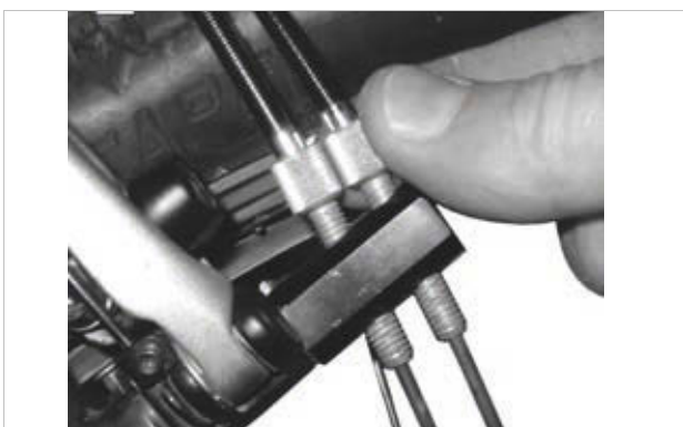
168. ábra: Belső váltóvezérléssel rendelkező ROHLOFF agyváltozatok húzásbeállítója a húzásellentartón van
