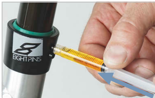
140. ábra: eightpins nyeregcső kenése
