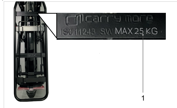
Abbildung 132: Auf dem Gepäckträger ist seine maximale Tragfähigkeit (1) ausgewiesen.
