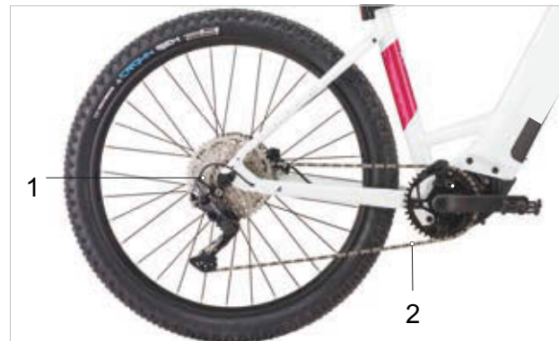
Afbeelding 30: Schema kettingaandrijving met derailleur
