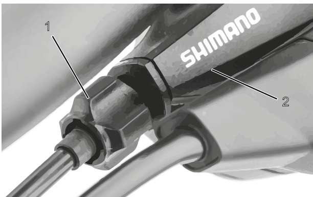
Figura 92: Casquillo de ajuste (1) del cambio de marchas accionado por cable de accionamiento con carcasa de la palanca de cambio (2), ejemplo
