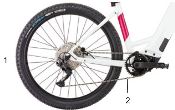
Figura 19: Esquema de la transmisión por cadena con cambio de cadena
