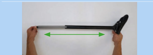
Figura 150: Separación de la tija de sillín
