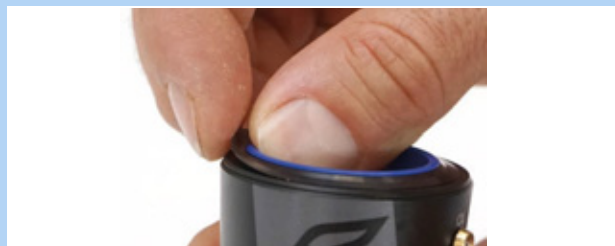
Figura 141: Retirada del anillo con falda de obturación
