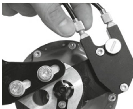
Figura 91: Las versiones de bujes Rohloff con activación de cambio externa tienen los dispositivos de ajuste de tensión en la caja de cables que se encuentra en el lado izquierdo
