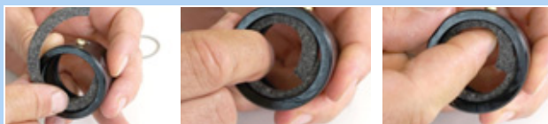
Figura 111: Inserción del anillo de fieltro
