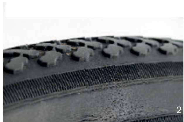
Abbildung 86: Beispiele für Ermüdungsrisse (1) und Alterungsrisse (2)
