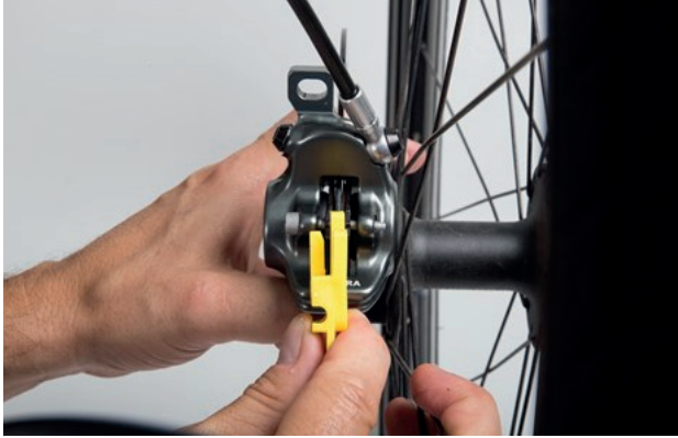
Abbildung 87: Bremsbelag im eingebauten Zustand mithilfe der Transportsicherung prüfen
