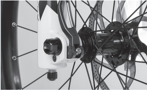
Abbildung 94: Spannkraft des Schnellspanners einstellen
