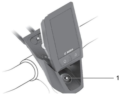
Abbildung 72: Lage Steuersatzschraube
