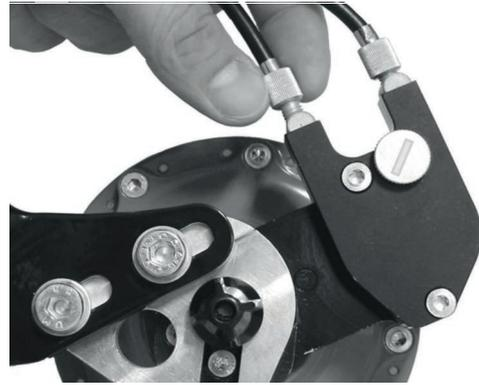
Abbildung 106: ROHLOFF-Naben Versionen mit externer Schaltungsteuerung haben die Zugeinsteller an der Seilbox, die sich auf der linken Seite befindet
