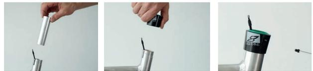
Abbildung 136: Gleitbuchse und Außenhülse einbauen
