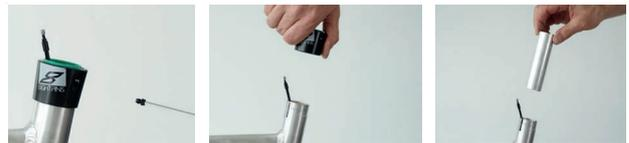
Abbildung 154: Außenhülse und Gleitbuchse ausbauen
