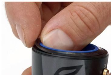
Abbildung 155: Dichtlippenring abziehen
