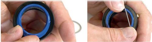
Abbildung 126: Abstreifer einlegen und befestigen
