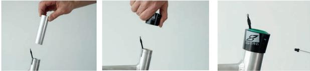
Abbildung 169: Gleitbuchse und Außenhülse einbauen
