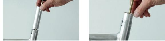
Abbildung 143: Gleitbuchsenrohr ins Sattelrohr stecken
