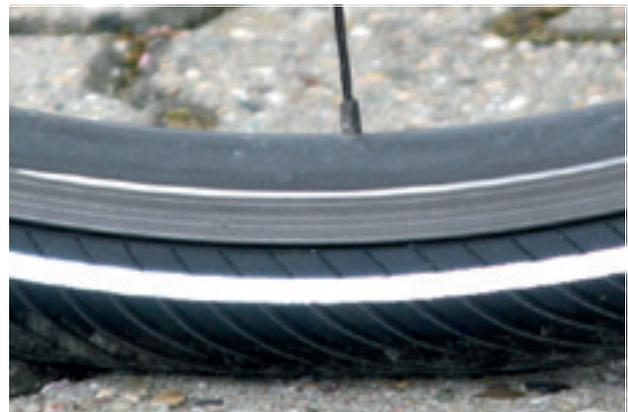
**Abbildung 60: Korrekter Fülldruck. Der Reifen ist unter der Last des Körpergewichts kaum verformt.**
