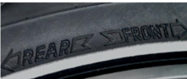
Abbildung 38: Laufrichtungspfeil auf MTB Reifen
