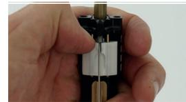
Abbildung 138: Weißer Betätigungsschieber nach unten schieben
