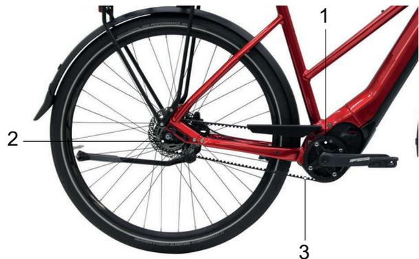
Abbildung 20: Schema Riemenantrieb
