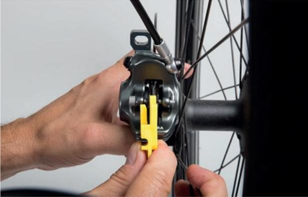
Abbildung 102: Bremsbelag im eingebauten Zustand mithilfe der Transportsicherung prüfen
