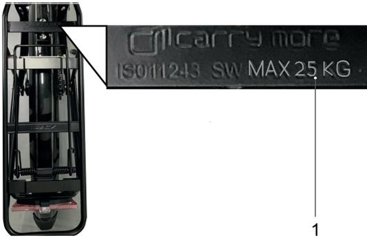
Abbildung 81: Auf dem Gepäckträger ist seine maximale Tragfähigkeit (1) ausgewiesen.
