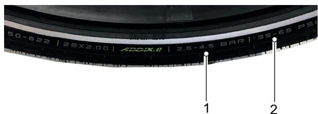
Abbildung 99: Fülldruck in bar (1) und psi (2)
