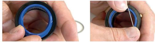
Abbildung 161: Abstreifer einlegen und befestigen
