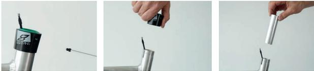
Abbildung 120: Außenhülle und Gleitbuchse ausbauen
