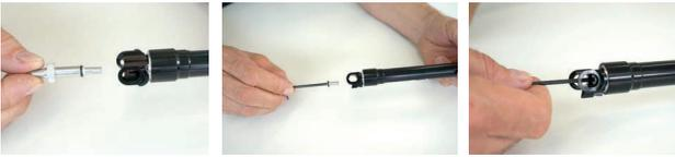
Abbildung 131: Kartusche Ventildeckel befestigen
