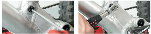
Abbildung 142: Postpin Achse befestigen
