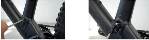
Abbildung 150: Sattelstütze lösen
