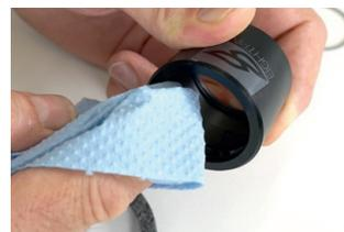
Abbildung 124: Außenhülle reinigen
