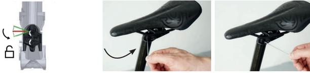
Abbildung 112: Höhenverstellungsbetätigung in „Geöffnete Stellung“ bringen
