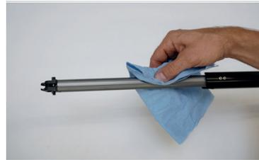
Abbildung 165: Längsführungsnut reinigen
