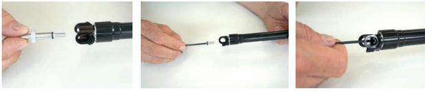
Abbildung 135: Kartusche Ventildeckel befestigen
