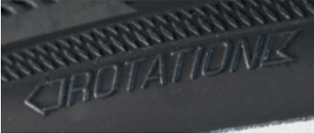
Abbildung 37: Laufrichtungspfeil
