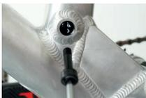
Abbildung 115: Postpin Achse lösen
