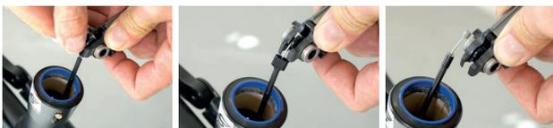
Abbildung 153: Bowdenzug entfernen
