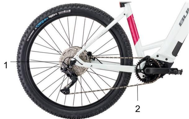
Abbildung 19: Schema Kettenantrieb mit Kettenschaltung
