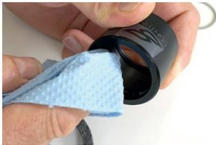
Abbildung 159: Außenhülse reinigen
