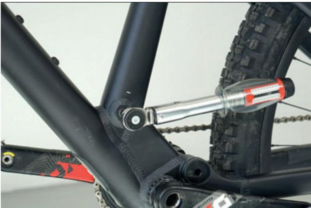
Abbildung 44: Sattelstützen-Achse anziehen
