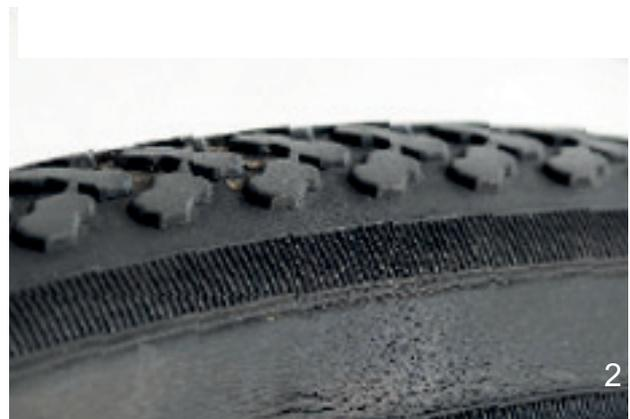
Abbildung 101: Beispiele für Ermüdungsrisse (1) und Alterungsrisse (2)
