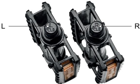
Abbildung 39: Beispiel Kennzeichnung von Pedalen
