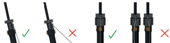
Abbildung 139: Korrekter und falscher Bowdenzug
