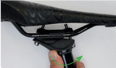
Abbildung 163: Höhenverstellung öffnen
