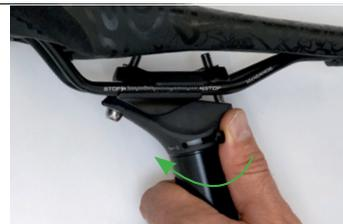
Abbildung 168: Höhenverstellung schließen
