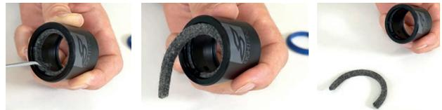
Abbildung 123: Filzring entfernen
