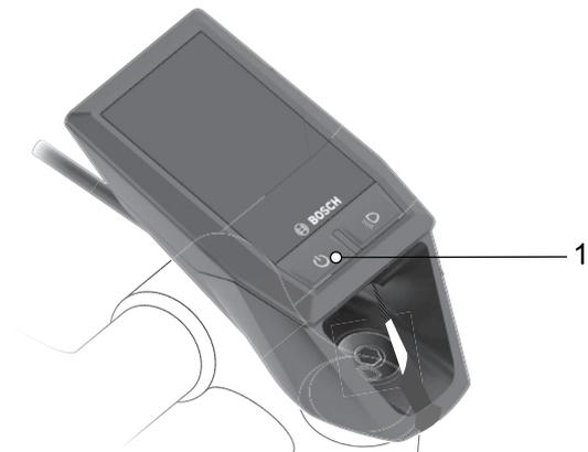
Abbildung 85: Lage Ein-Aus-Taster (Bedieneinheit)
