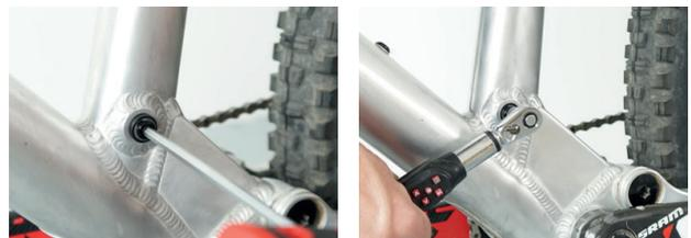
Abbildung 173: Sattelstütze festschrauben
