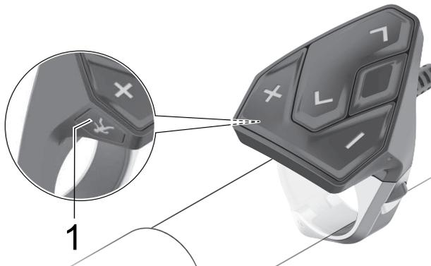
Abbildung 87: Lage Schiebehilfe-Taster auf der Bedieneinheit
