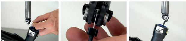
Abbildung 170: Sattelstütze aufhängen und einschieben
