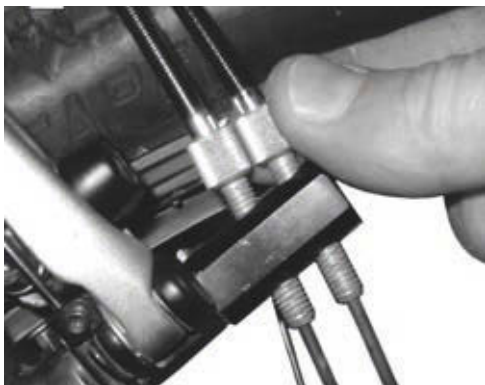
Afbeelding 157: Bij ROHLOFF naafversies met interne schakelaansturing zit de kabelafsteller op de tegenhouder van de kabel
