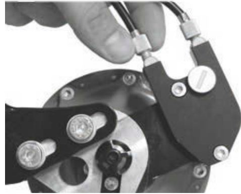
Afbeelding 158: Bij ROHLOFF naafversies met externe schakelaansturing zit de kabelafsteller op de kabelbox aan de linkerkzijde
