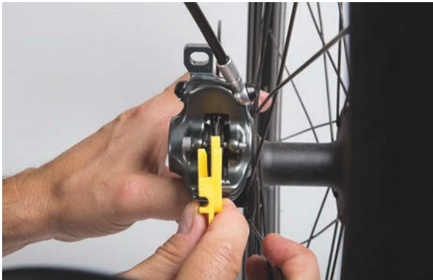
Afbeelding 143: Remvoering in gemonteerde toestand controleren met behulp van de transportbeveiliging
