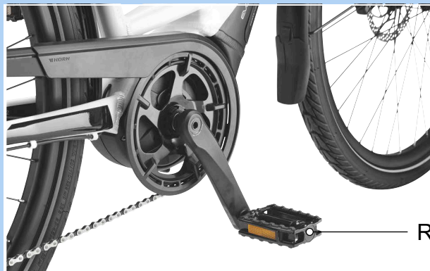
Afbeelding 50: R-pedaal in de rechter crankarm
