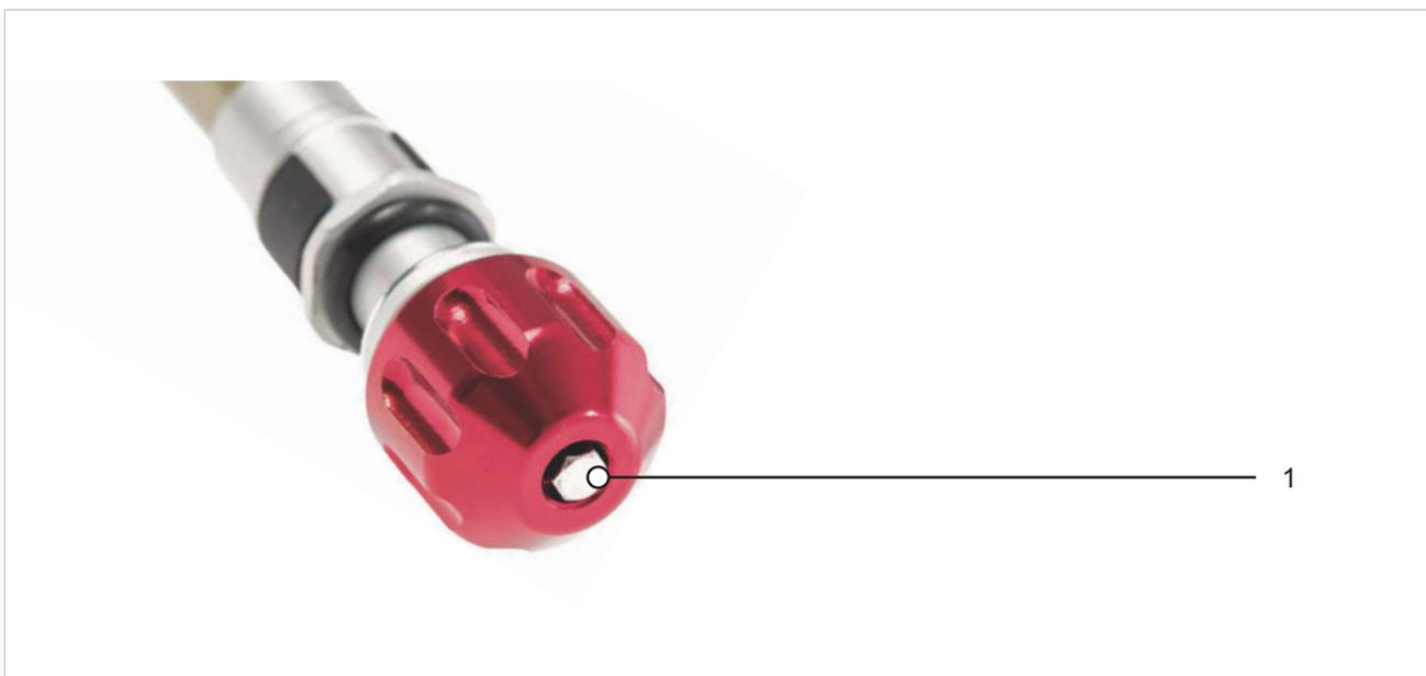
Figura 218: Ejemplo de **regulador de niveles de tracción (horquilla)** SR SUNTOUR (1)
