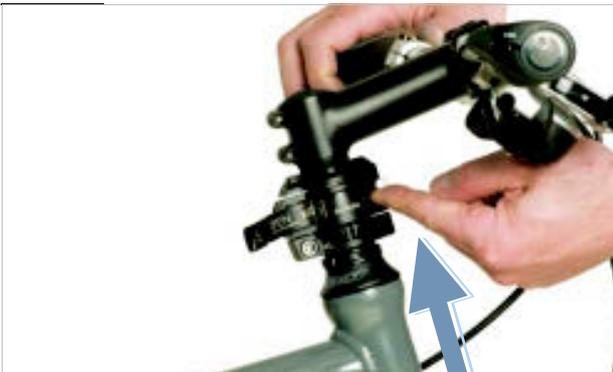
Figura 176: Presión hacia arriba del perno de desbloqueo
