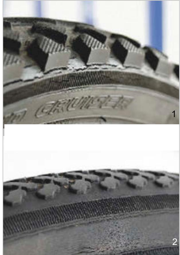
Figura 184: Ejemplos de fisuras por fatiga (1) y fisuras por envejecimiento (2)
