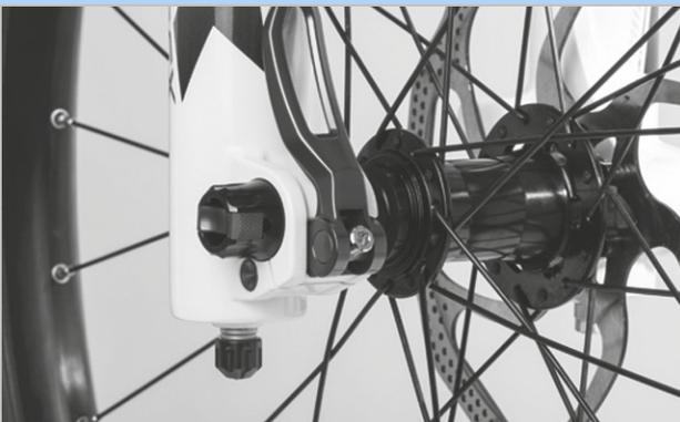
Figura 85: Posición perfecta de la palanca tensora
