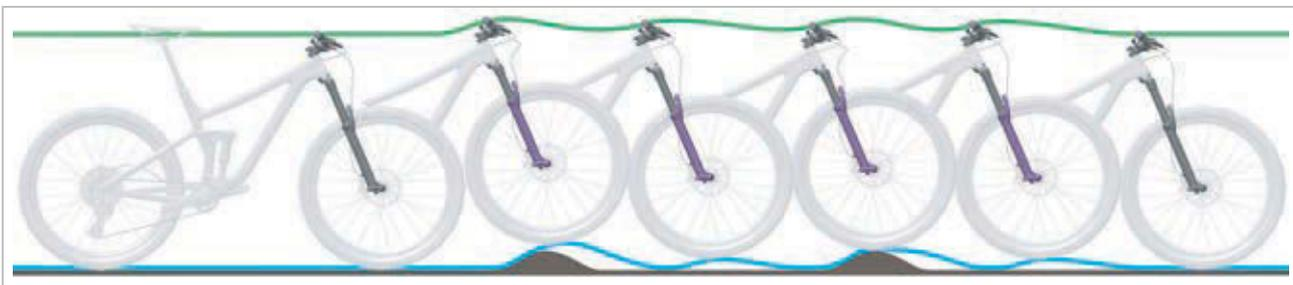
Figura 217: Descompresión demasiado rápida de la horquilla de suspensión
