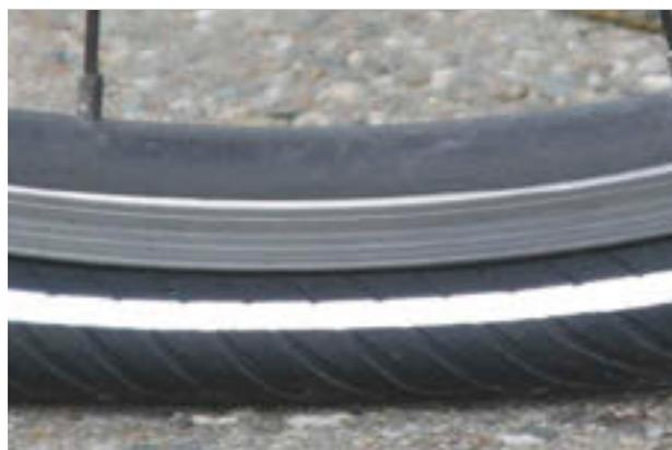
Figura 120: Presión de inflado demasiado baja
