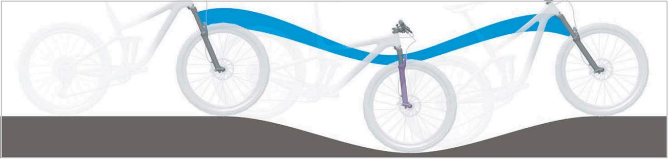
Figura 221: Suspensión de la horquilla de suspensión demasiado blanda en montaña
