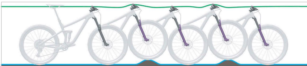
Figura 15: Condición óptima de marcha de la horquilla de suspensión
