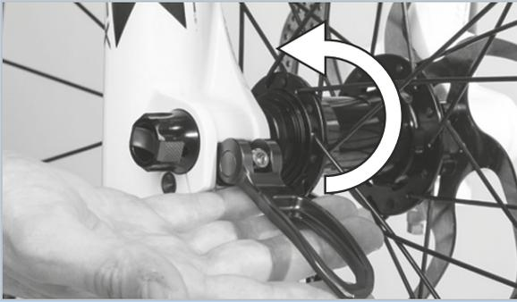
Figura 84: Presión de la palanca de cierre rápido en la dirección de la flecha
