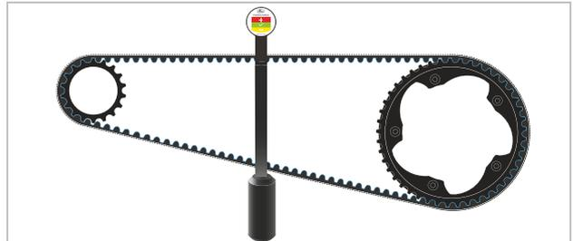
Figura 204: Varilla de medición enganchada
