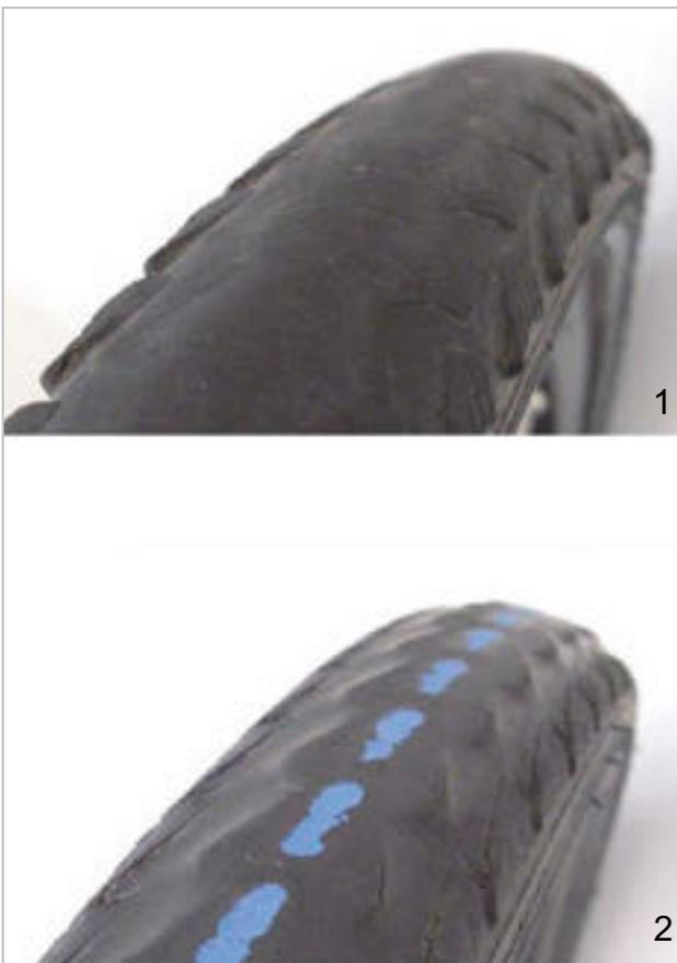
Figura 183: Cubierta sin perfil que puede cambiarse (1); cubierta con protección contra pinchazos visible (2) que tiene que cambiarse
