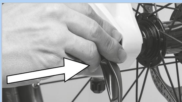
Figura 88: Inserción del cierre rápido en la dirección de la flecha
