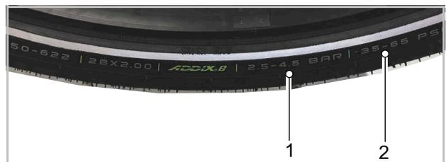
Figura 182: Indicación de presión de inflado en bar (1) y psi (2)
