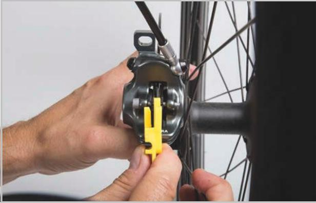
Figura 185: Comprobación de la almohadilla de freno montada con ayuda del seguro de transporte
