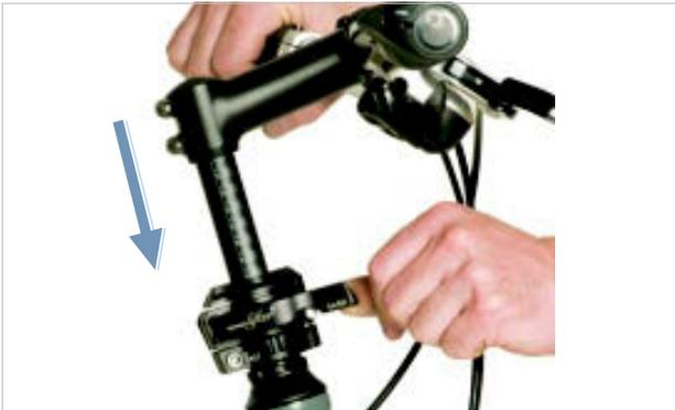
Figura 175: Ajuste de la altura
