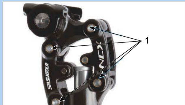
Figura 215: Puntos de lubricación de la tija de sillín de muelle SR SUNTOUR
