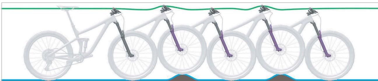
Figura 18: Condición óptima de marcha de la horquilla de suspensión
