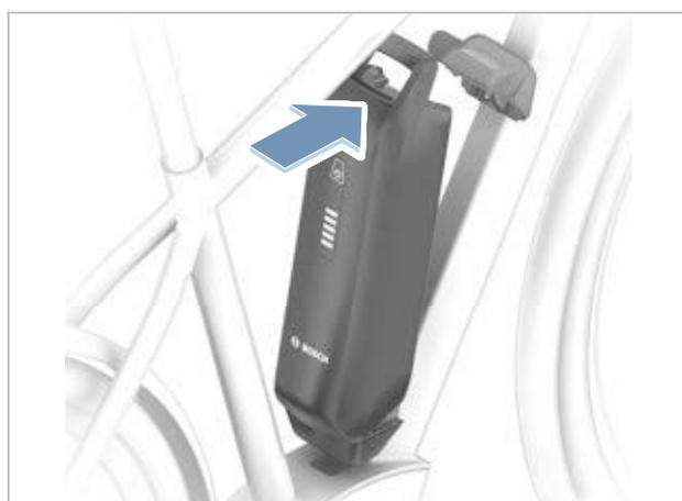
Figura 155: Plegado hacia arriba de la batería PowerPack
