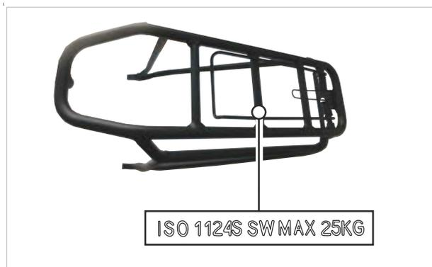
Figura 160: En el portaequipajes se indica la capacidad máxima de carga (1)
