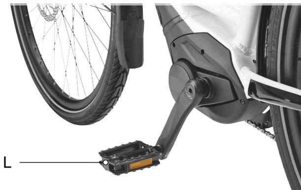
Figura 94: Pedal L en el brazo de manivela izquierdo
