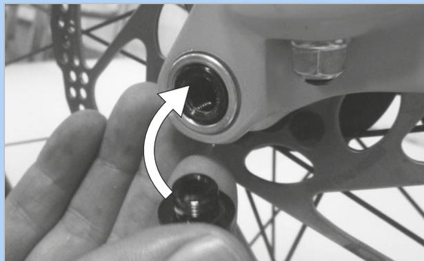
Figura 79: Insertar el tornillo de seguridad
