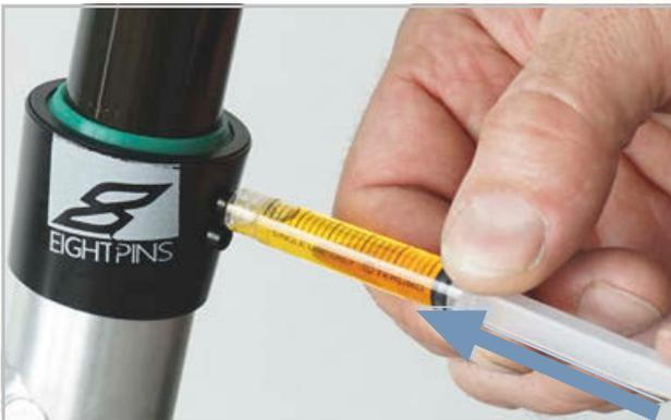
Figura 181: Lubricación de la tija de sillín EIGHTPINS
