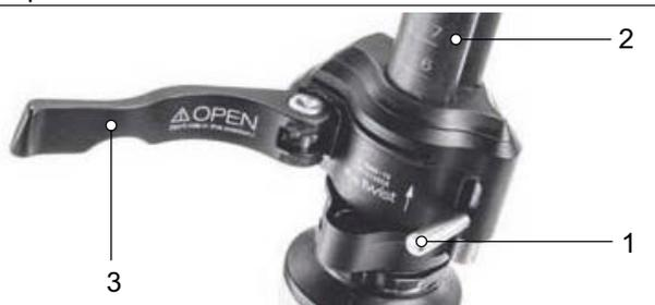
Figura 91: Palanca tensora abierta del cierre rápido de la potencia (3) en la potencia (2), versión I, con palanca de seguridad en la potencia (1)
