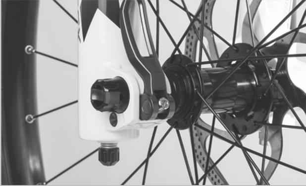
Figura 213: Ajuste de la fuerza de tensado del cierre rápido
