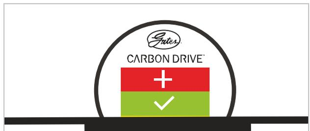
Figura 206: Ejemplo: En el borde amarillo inferior, por ello reducir la tensión de correa ligeramente
