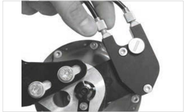
Figura 210: Las versiones de bujes ROHLOFF con activación de cambio externa tienen los dispositivos de ajuste de tensión en la caja de cables que se encuentra en el lado izquierdo
