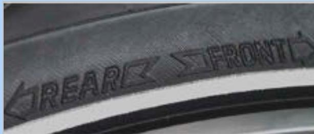
Figura 76: Flecha de sentido de la marcha en cubiertas de MTB
