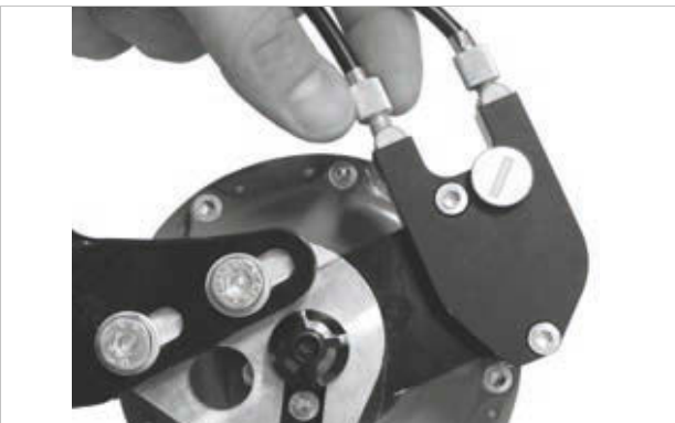
Afbeelding 210: Bij ROHLOFF naafversies met externe schakelaansturing zit de kabelafsteller op de kabelbox aan de linkerkzijde
