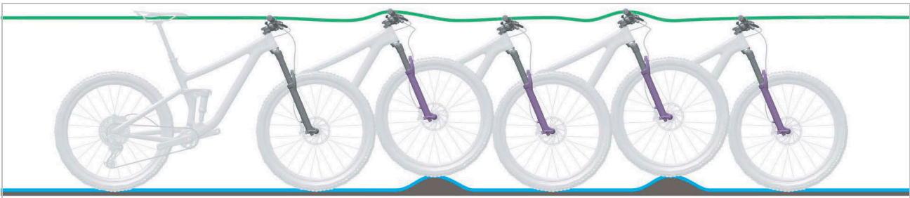
Afbeelding 15: Optimaal rijgedrag van de verende voorvork
