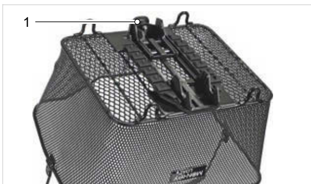
Afbeelding 142: Mand met MonkeyLoad adapterplaat en trekknop (1)
