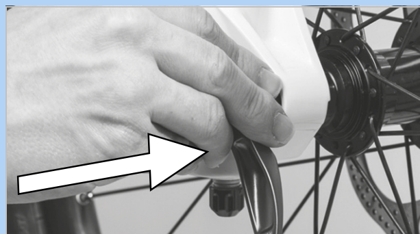
Afbeelding 88: Snelspanner in de richting van de pijl inschuiven
