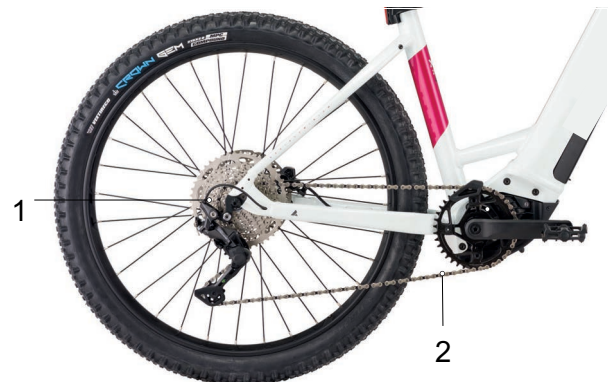
Abbildung 18: Schema Kettenantrieb mit Kettenschaltung
