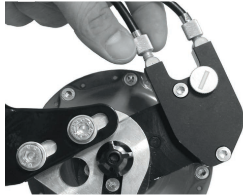
Abbildung 122: ROHLOFF-Naben Versionen mit externer Schaltansteuerung haben die Zugeinsteller an der Seilbox, die sich auf der linken Seite befindet
