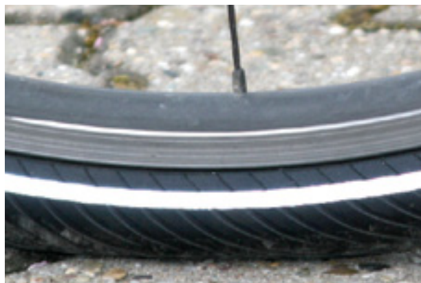
Figur 57: Korrekt dæktryk. Dækkets form er næsten ikke ændret af kropsvægtens belastning
