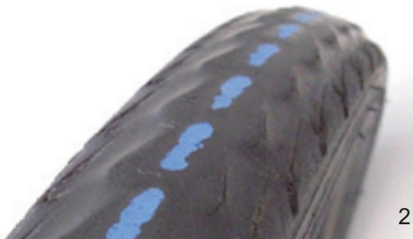
Figur 85: Dæk uden profil, som kan udskiftes (1), og dæk, hvor punkteringsbeskyttelsen (2) kan ses gennem slidbanen, og som skal udskiftes
