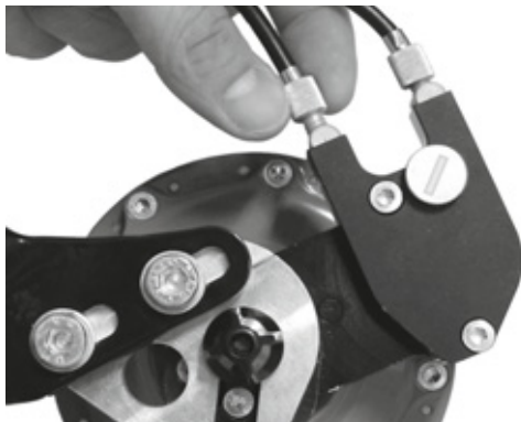
Figur 91: På udgaver af ROHLOFF-nav med ekstern skifteaktivering sidder kabelindstilleren på wireboksen, som sidder på venstre side
