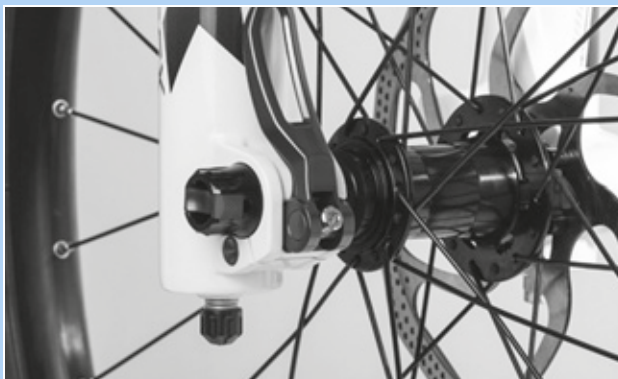
Figur 95: Indstilling af hurtigbespændingens spændekraft
