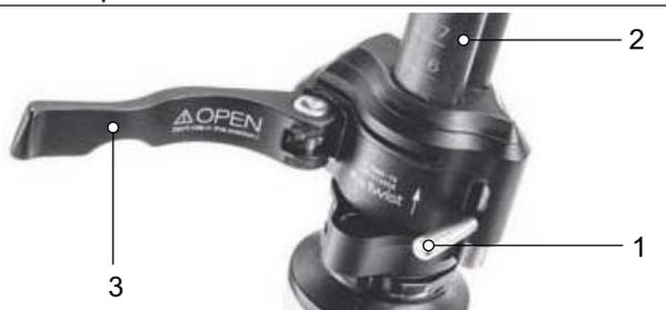
Illustration 57 : Levier de serrage ouvert de l'attache rapide de la potence (3) sur la potence (2), modèle I, avec levier de blocage sur la potence (1)
