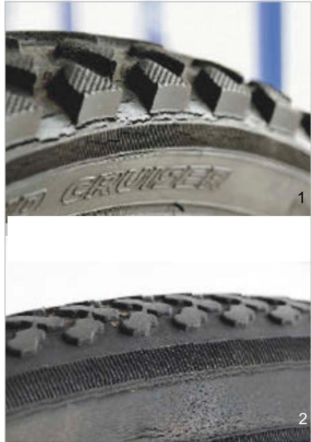
Illustration 135 : Exemples de fissures de fatigue (1) et de fissures d'âge (2)
