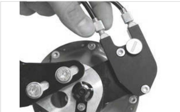
Illustration 151 : Sur les versions de moyeux ROHLOFF avec commande externe du changement de vitesse, le dispositif de réglage de la tension est situé sur le boîtier de câbles qui est placé sur le côté gauche
