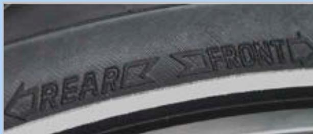
Illustration 56 : Flèche directionnelle sur les pneus VTT
