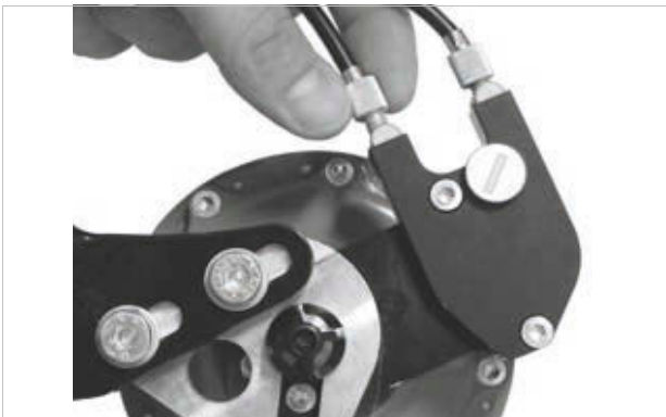
Figur 155: På udgaver af ROHLOFF-nav med ekstern skifteaktivering sidder kabelindstilleren på wireboksen, som sidder på venstre side
