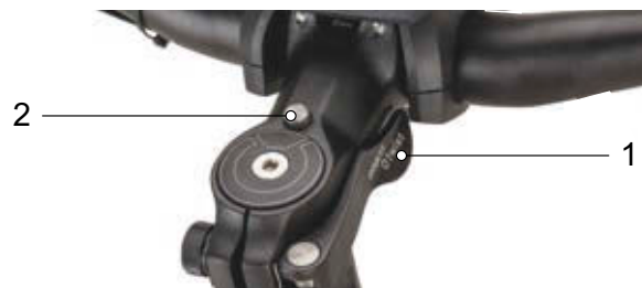
Figur 58: Frempind, udførelse II med greb på frempindens hurtigbespænding (1) og frigørelsesknapp (2)
