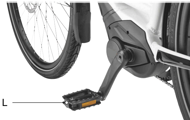
Afbeelding 60: L-pedaal in de linker crankarm
