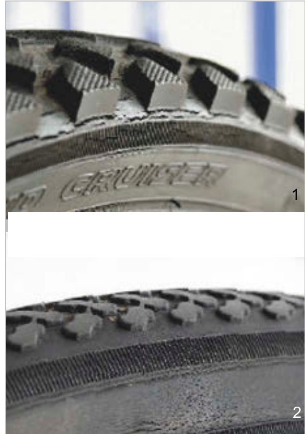
Afbeelding 139: Voorbeelden van vermoeiingsscheuren (1) en verouderingsscheuren (2)
