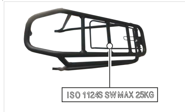
117. ábra: A csomagtartón fel van tüntetve a maximális teherbírása (1)
