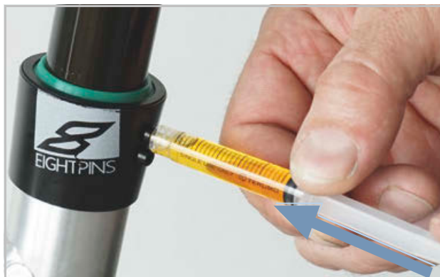
132. ábra: EIGHTPINS nyeregcső kenése
