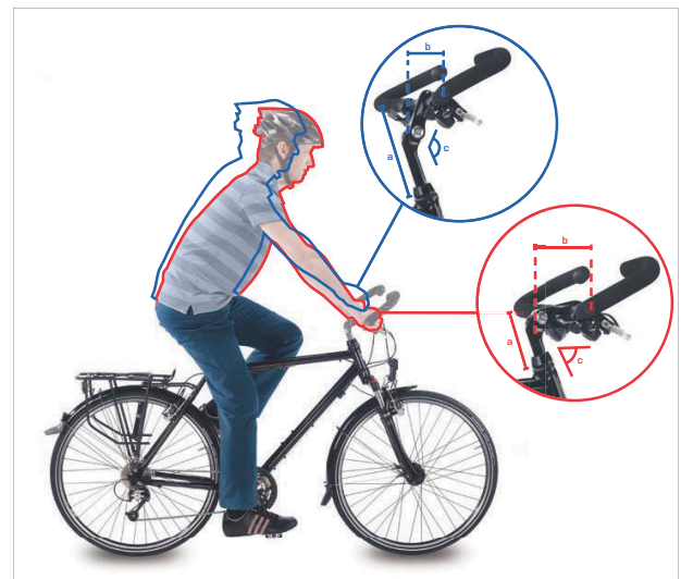
84. ábra: Városi kerékpár (kék) és túrakerékpár (piros) a szög változtatásával
