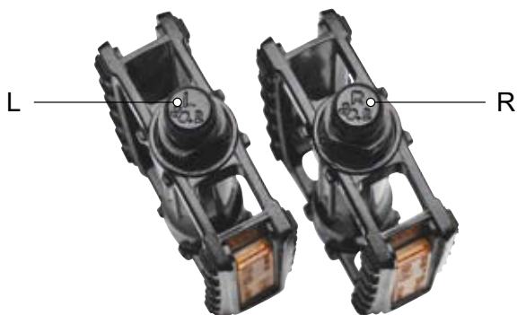
Illustration 59 : Exemple de marquage de pédales
