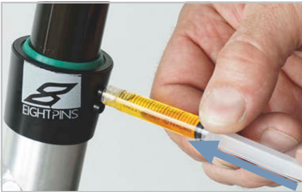
Illustration 136 : Lubrifier une tige de selle EIGHTPINS
