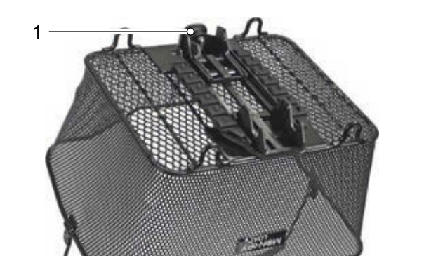
Illustration 104 : Panier avec plaque d'adaptation et bouton à tirer MonkeyLoad (1)
