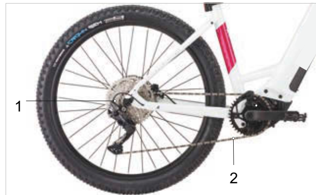
Illustration 30 : Schéma de l'entraînement à chaîne avec dérailleur
