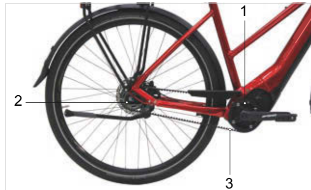
Illustration 31 : Schéma de l'entraînement à courroie
