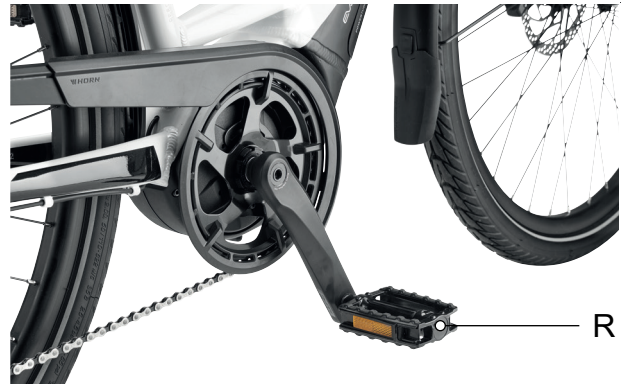
Abbildung 63: R Pedal im rechten Kurbelarm
