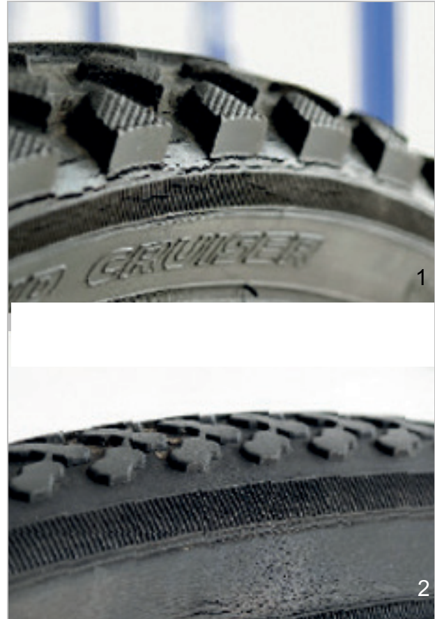
Abbildung 140: Beispiele für Ermüdungsrisse (1) und Alterungsrisse (2)
