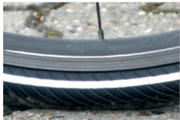
Abbildung 87: Korrekter Fülldruck. Der Reifen ist unter der Last des Körpergewichts kaum verformt
