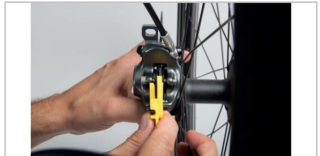
Abbildung 170: Bremsbelag im eingebauten Zustand mithilfe der Transportsicherung prüfen
